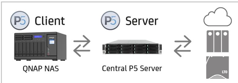
Archiware P5 kann mit einem QNAP NAS in zwei verschiedenen Konfigurationen kombiniert werden. Im ersten Setup fungiert P5 als zentraler Server, der Daten vom QNAP NAS auf das gewünschte Ziel (Disk, Tape oder Cloud) synchronisiert, sichert oder klonnt.
