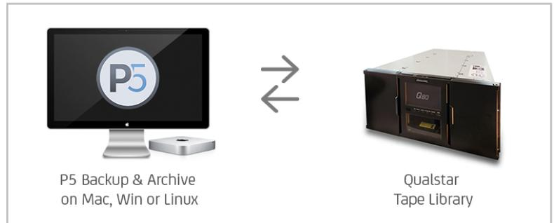
Um die Produktionsdaten täglich zu sichern, nutzen Sie einen Teil Ihrer Qualstar Library für regelmäßige volle oder inkrementelle Sicherungen mit **Archiware P5 Backup**. Da die Position der Files auf dem Band gespeichert wird, erfolgt der Restore im Bedarfsfall sehr schnell. Parallelisierung mehrerer Laufwerke sorgt für maximalen Durchsatz. Optimale Datensicherheit wird erreicht, indem Tapes geklont und außer Haus gelagert werden.
